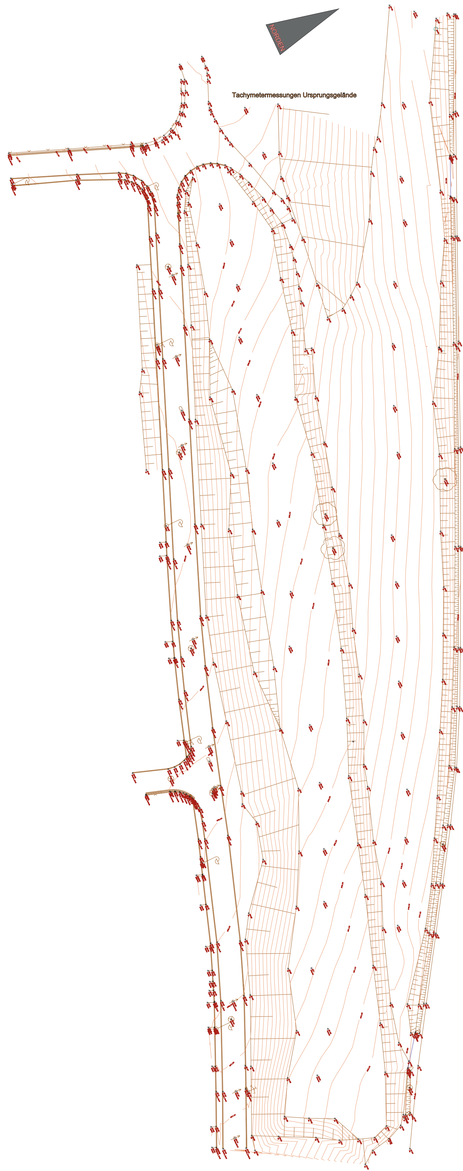
Tachymetermessungen des gesamten Geländes inkl. vielen Fest-/Referenzpunkten
